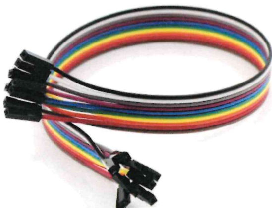
Рисунок 2 – Пример соединительного провода
